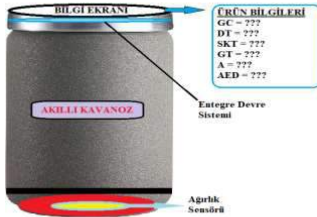
Şekil 3. Akıllı kavanoz tasarımına ait fiziksel şema
