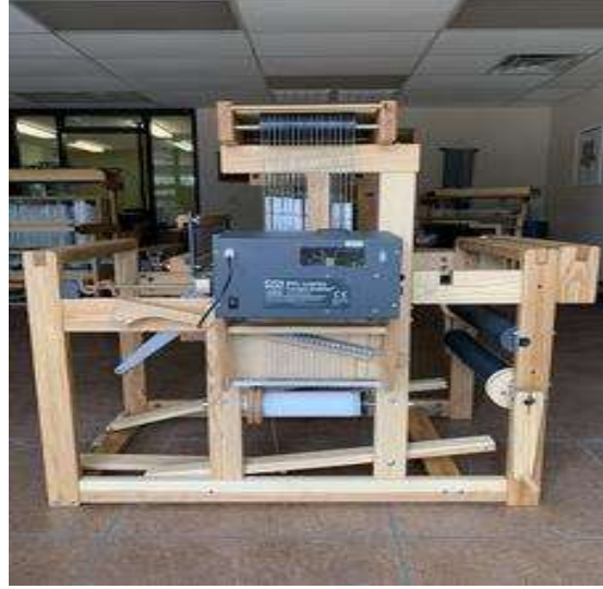
Şekil 2. Studio Dobby Loom yarı-otomatik numune dokuma tezgahı
