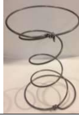
Şekil 4. Geliştirilen tellerden elde edilen yay numunesi
