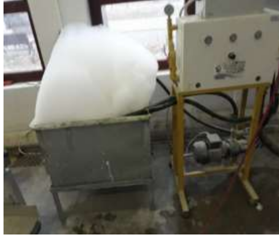
Şekil 4. Laboratuvar ortamında köpük jeneratöründen köpük elde edilmesi
