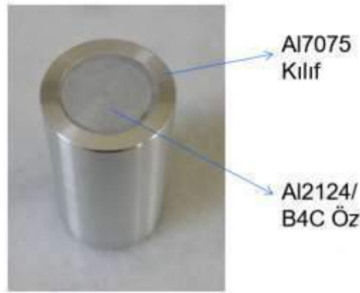
Şekil 2. Powder in tube yöntemi ile üretilen ekstrüzyon biletleri.
