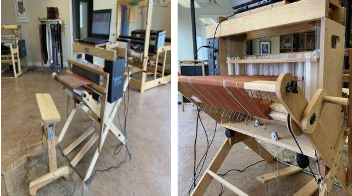
Şekil 1. Workshop Dobby Loom yarı-otomatik numune dokuma tezgahı
