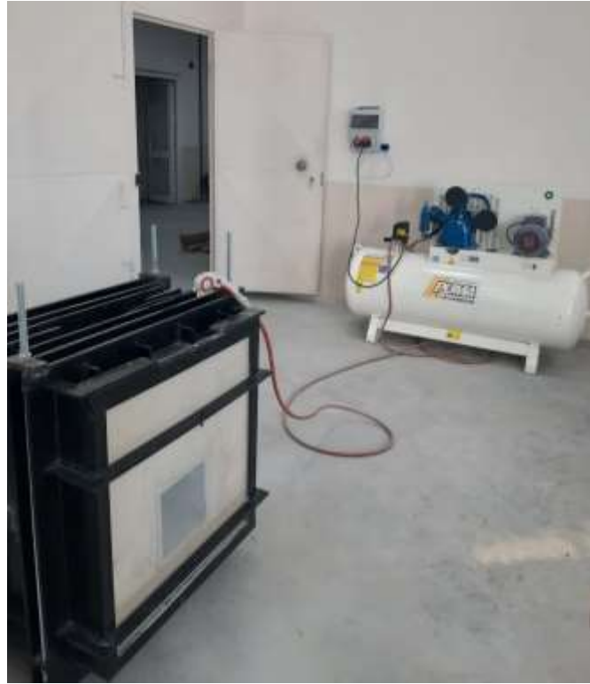
Şekil 3.5 Hava Kompresörü İle Sürsaj Yükün Verilmesi
