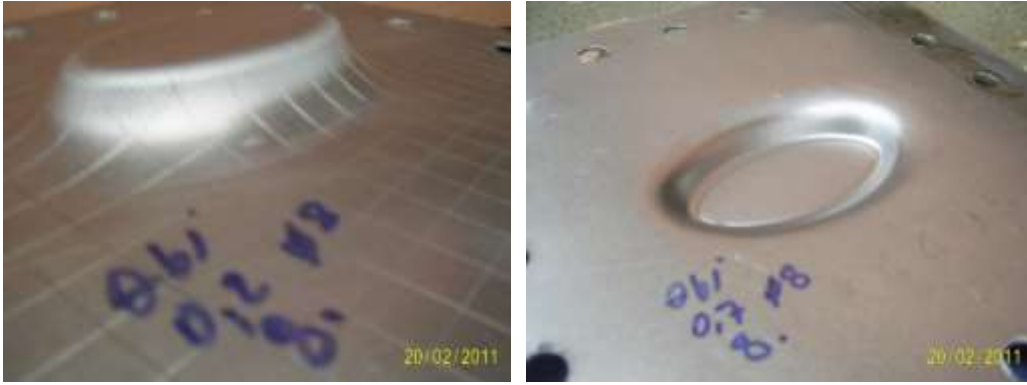
Şekil 5.8 Adım ( \Delta z ) = 0.7 mm, küresel uç çapı ( \emptyset ) = 8 mm, duvar açısı ( \theta ) = 61°
