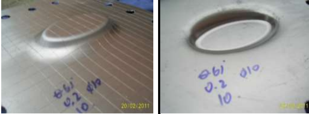
Şekil 5.10 Adım ( \Delta z ) =0.2 mm, küresel uç çapı ( \emptyset ) =10 mm, duvar açısı ( \theta )= 61°
