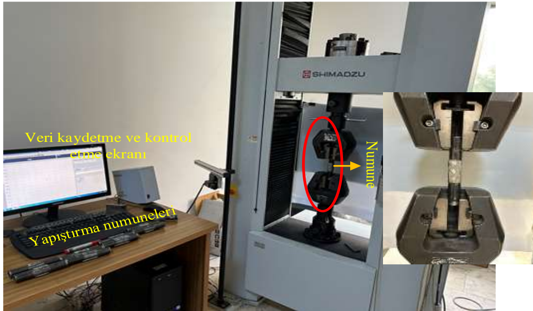
Şekil 4. Shimadzu AG-X 250 kN universal çekme cihazı
