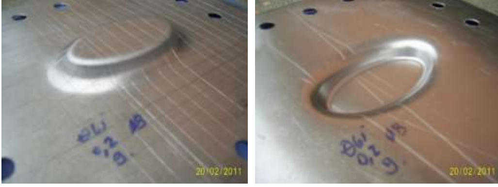
Şekil 5.9 Adım ( \Delta z ) =0.2 mm, küresel uç çapı ( \emptyset ) =8 mm, duvar açısı ( \theta )= 61°
