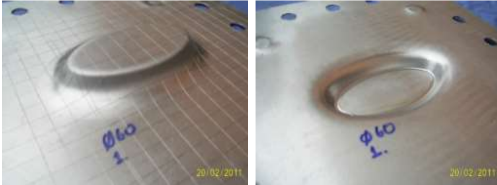
Şekil 5.1 Adım ( \Delta z ) = 0.2 mm, küresel uç çapı ( \varnothing ) = 6 mm, duvar açısı ( \theta ) = 60^\circ
