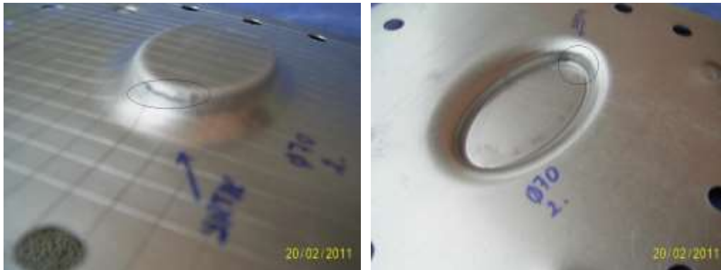
Şekil 5.2 Adım ( \Delta z ) = 0.2 mm, küresel uç çapı ( \varnothing ) = 6 mm, duvar açısı ( \theta ) = 70^\circ
