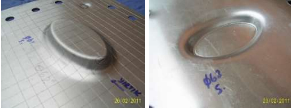
Şekil 5.5 Adım ( \Delta z ) = 0.2 mm, küresel uç çapı ( \emptyset ) = 6 mm, duvar açısı ( \theta ) = 62°
