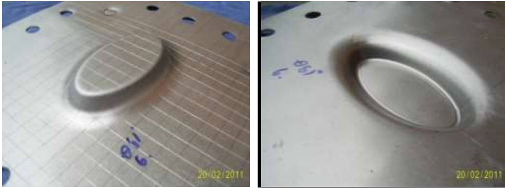
Şekil 5.6 Adım ( \Delta z ) = 0.2 mm, küresel uç çapı ( \emptyset ) = 6 mm, duvar açısı ( \theta ) = 61°
