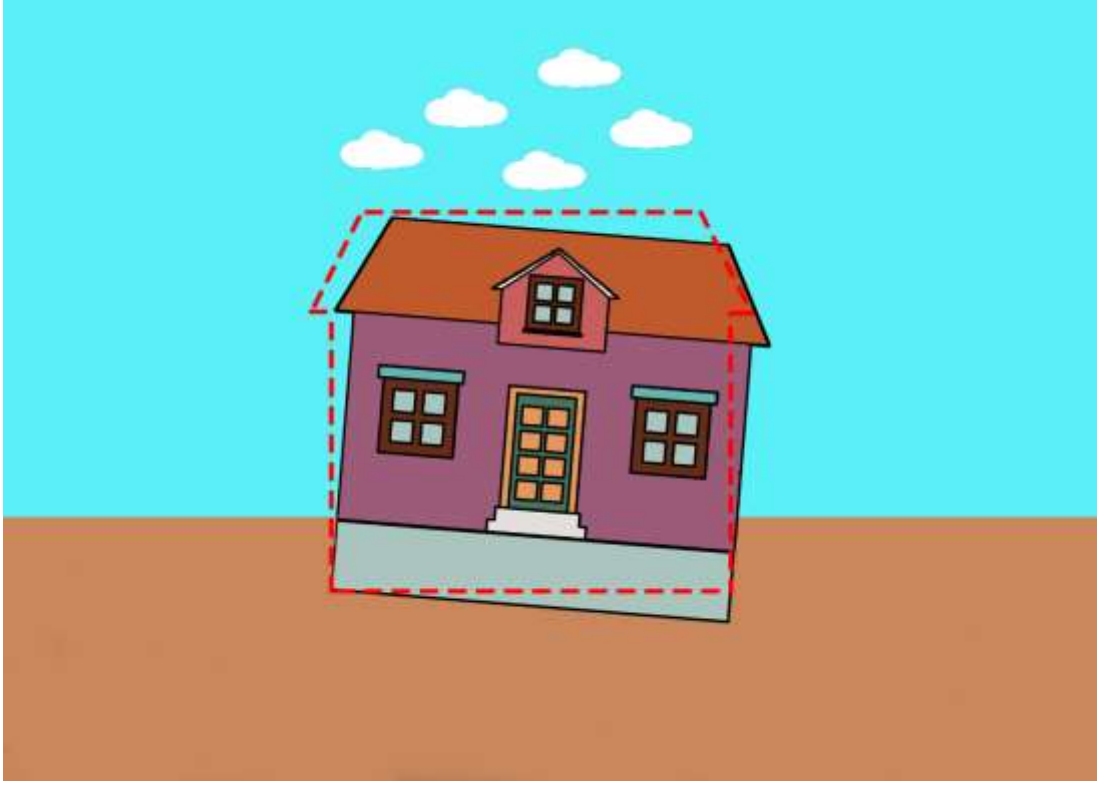
Şekil 4. Yapının Yan Yatması
