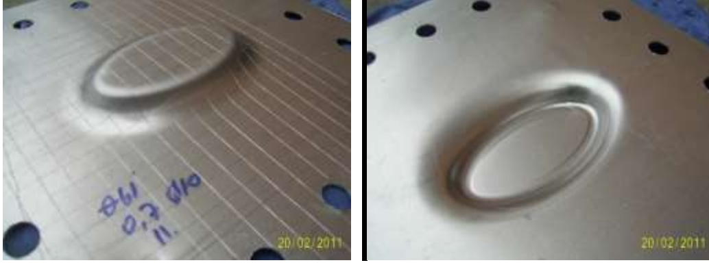
Şekil 5.11 Adım ( \Delta z ) = 0.7 mm, küresel uç çapı ( \emptyset ) = 10 mm, duvar açısı ( \theta ) = 61°
