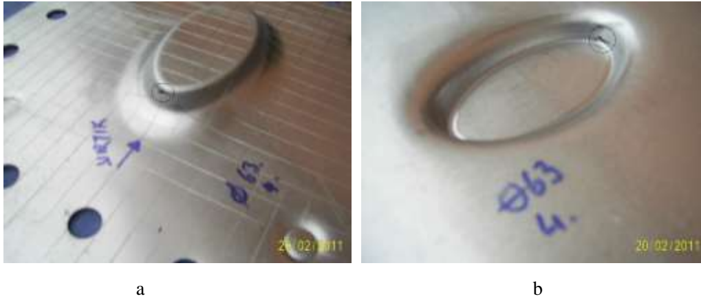
Şekil 5.4 Adım ( \Delta z ) = 0.2 mm, küresel uç çapı ( \emptyset ) = 6 mm, duvar açısı ( \theta ) = 63^\circ
