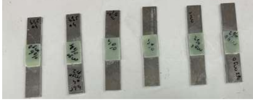
Şekil 1. MgO takviyesi ile yapılan yapıştırma bağlantıların görüntüleri
