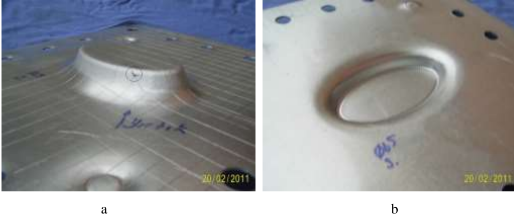
Şekil 5.3 Adım ( \Delta z ) = 0.2 mm, küresel uç çapı ( \emptyset ) = 6 mm, duvar açısı ( \theta ) = 65^\circ
