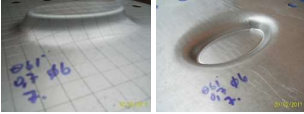
Şekil 5.7 Adım ( \Delta z ) = 0.7 mm, küresel uç çapı ( \emptyset ) = 6 mm, duvar açısı ( \theta ) = 61°
