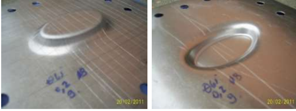
Şekil 5.9 Adım ( \Delta z ) = 0.2 mm, küresel uç çapı ( \varnothing ) = 8 mm, duvar açısı ( \theta ) = 61°
