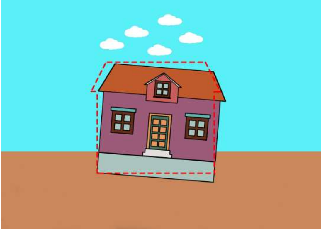
Şekil 4. Yapının Yan Yatması
