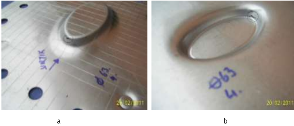
Şekil 5.4 Adım ( \Delta z ) = 0.2 mm, küresel uç çapı ( \varnothing ) = 6 mm, duvar açısı ( \theta ) = 63^\circ
