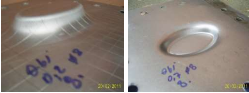
Şekil 5.8 Adım ( \Delta z ) = 0.7 mm, küresel uç çapı ( \varnothing ) = 8 mm, duvar açısı ( \theta ) = 61°
