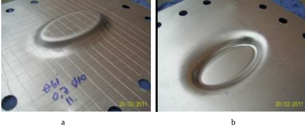
Şekil 5.11 Adım ( \Delta z ) = 0.7 mm, küresel uç çapı ( \varnothing ) = 10 mm, duvar açısı ( \theta ) = 61°
