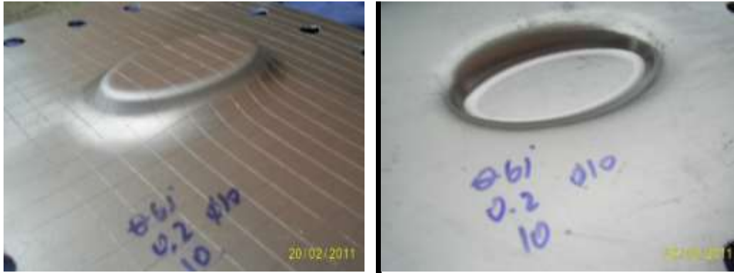
Şekil 5.10 Adım ( \Delta z ) = 0.2 mm, küresel uç çapı ( \varnothing ) = 10 mm, duvar açısı ( \theta ) = 61°
