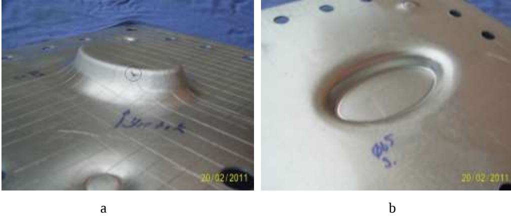
Şekil 5.3 Adım ( \Delta z ) = 0.2 mm, küresel uç çapı ( \varnothing ) = 6 mm, duvar açısı ( \theta ) = 65^\circ
