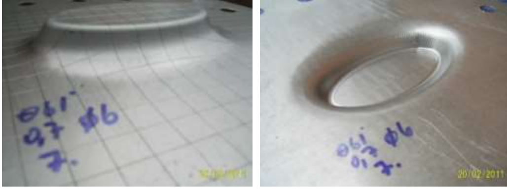
Şekil 5.7 Adım ( \Delta z ) = 0.7 mm, küresel uç çapı ( \varnothing ) = 6 mm, duvar açısı ( \theta ) = 61°
