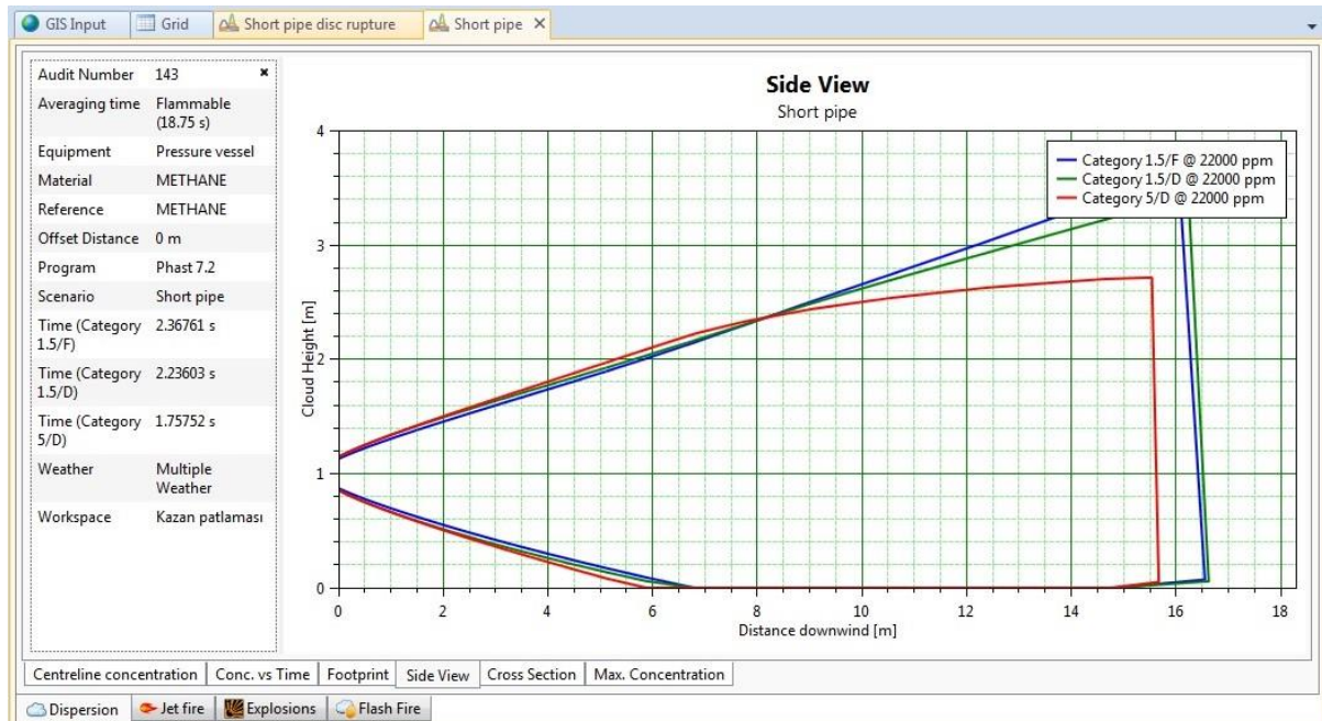
Şekil 7. Kısa boru yırtılması senaryosunda, yandan kesit görüntüsü
