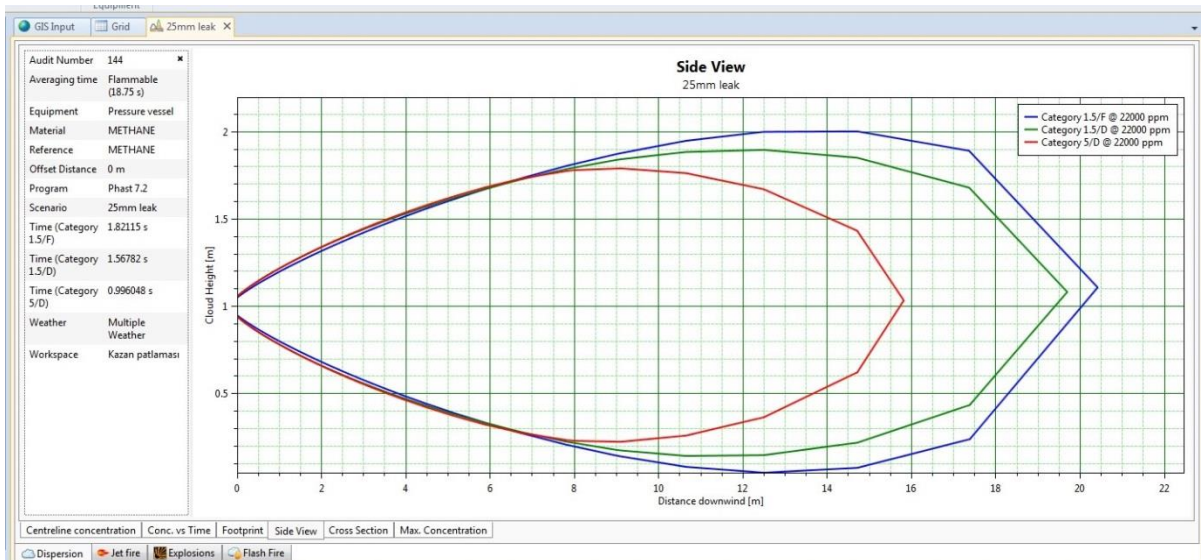
Şekil 2. 25 mm sızıntı senaryosunda, yandan kesit görüntüsü
