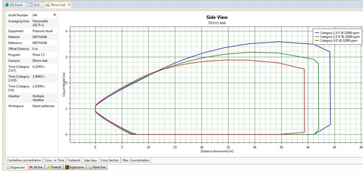
Şekil 3. 50mm sızıntı senaryosunda, yandan kesit görüntüsü
