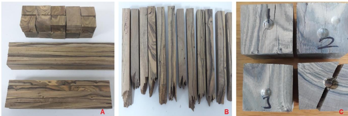
Şekil 3. Deney numunelerinin genel görünümü (A), Dinamik eğilme (şok) direnci numunelerinin deney sonrasındaki görünümü (B), Statik sertlik deney numunelerinin deney sonrasındaki görünümü (C).
