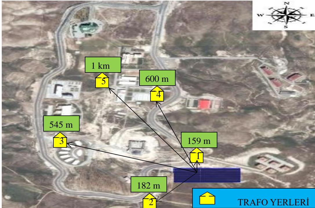
Şekil 5. Batı raman kampüsündeki trafo yerleri ve GES'e mesafeleri
